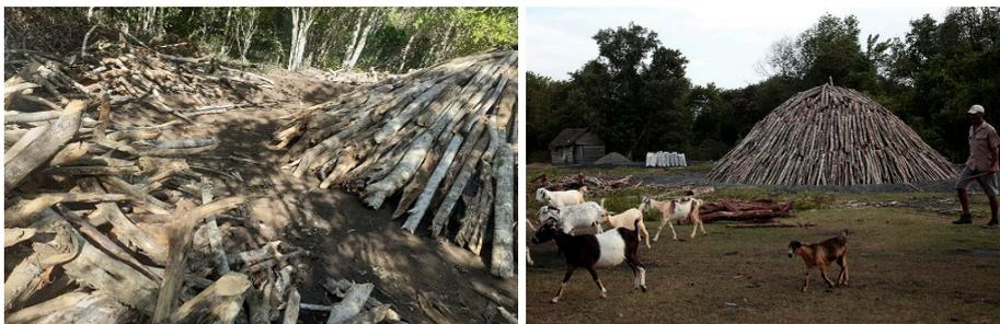
Figura: 3 Conformación del horno en el sitio previamente seleccionado y acondicionado.
