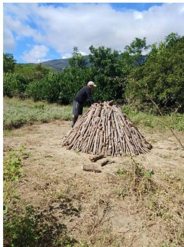
Figura 2. Conformación del horno en el sitio previamente seleccionado y acondicionado.
